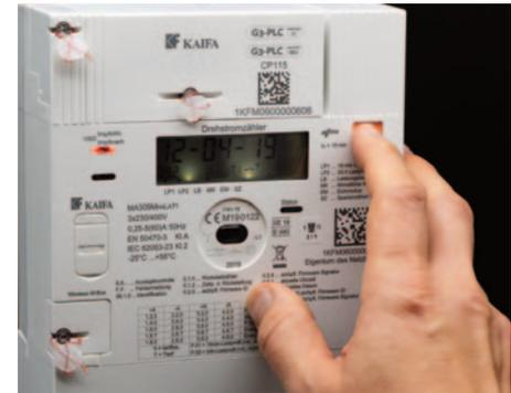
Bei Wiederinbetriebnahme einer Anlage wird der Smart Meter von der IKB aus der Ferne auf „bereit zur Wiedereinschaltung“ aktiviert. Aus Sicherheitsgründen muss der Zähler (ausgenommen Zählertausch) vor Ort durch den Kunden selbst in Betrieb genommen werden.
