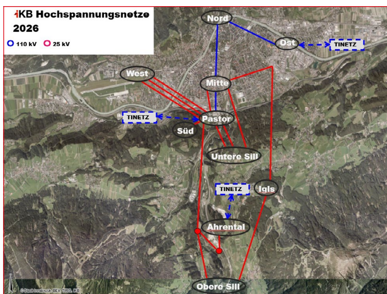
Abbildung 2: Schematische Darstellung des 110- und 25-kV-Netzes
