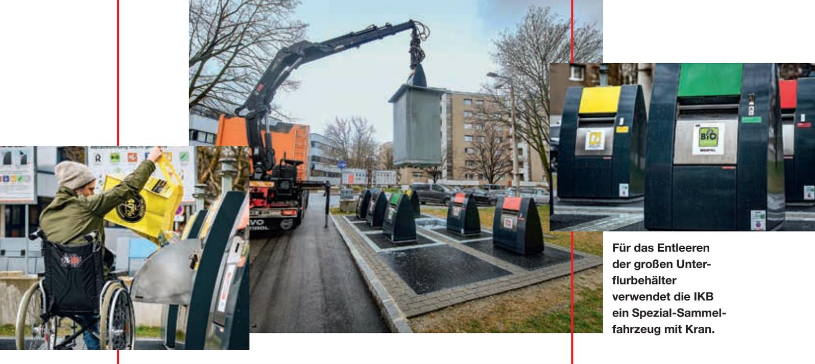
Für das Entleeren der großen Unterflurbehälter verwendet die IKB ein Spezial-Sammel-fahrzeug mit Kran.
